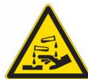
Pericolo sostanze corrosive W023
