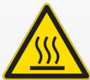
Pericolo superficie calda W017
