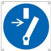
È obbligatorio disconnettere il macchinario prima di effettuare manutenzioni o riparazioni M021
