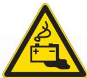
Pericolo batterie in fase di carica W026
