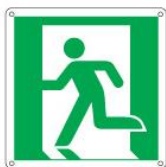
Uscita di emergenza a sinistra E001
