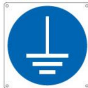
È obbligatorio assicurarsi del collegamento a terra M005
