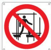
Vietato l'uso di questa impalcatura incompleta P025 ●
