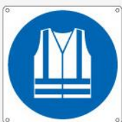
È obbligatorio indossare indumenti ad alta visibilità M015
