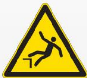
Pericolo di caduta con dislivello W008
